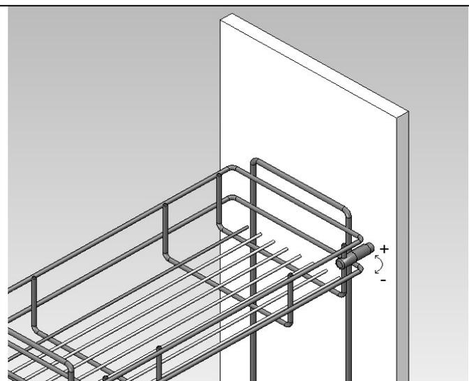
Ruotare la parte "B" (+ o -) per regolare la posizione dell'anta, serrare il grano "1".
